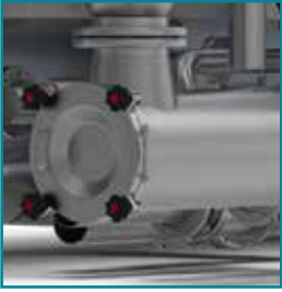
Alt kolektör ve filtre haznesi Lower collector and filter chamber
