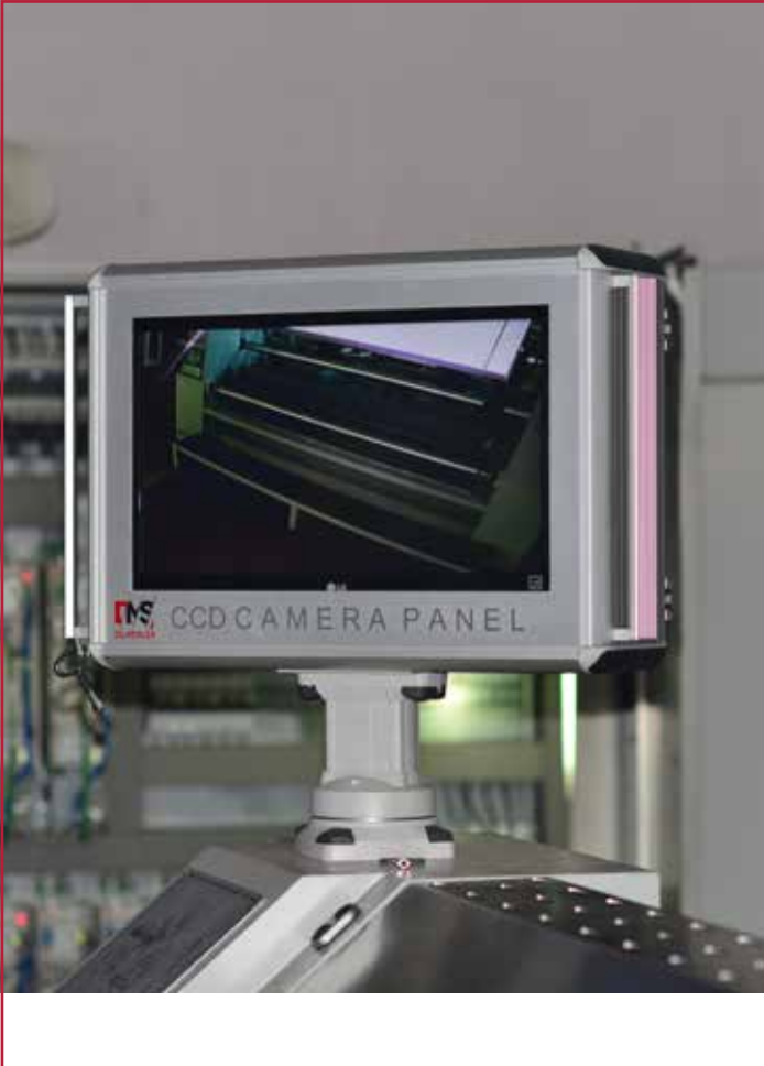
Geri Görüş Kamerası (Kumaş Çıkış Görüş) LCD Screen for the back of the machine
