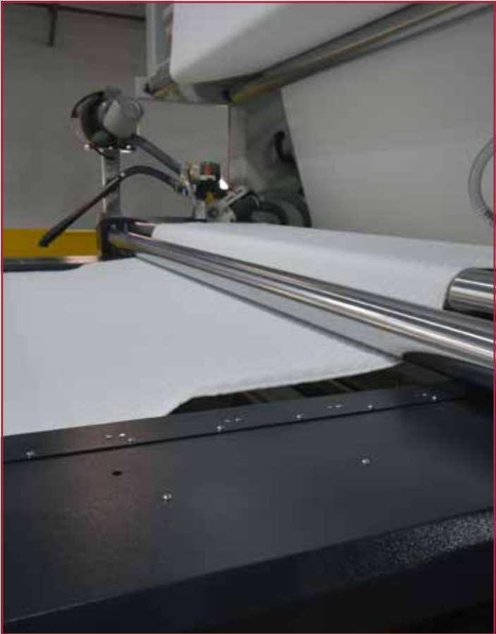
Çıkışta kumaşı iğneden ayıran disk sistemi Fabric unpinning unit
